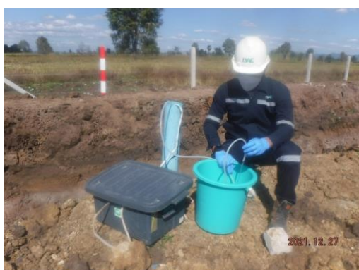
บ่อสังเกตการณ์ภายในฐานหลุมผลิต TRE-1 ในทิศทางเหนือน้ำ : MWTRE-1 (Up Gradient)
